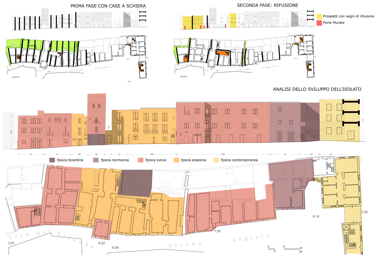
Fig. 10 - Esempio di trasformazione per intasamento di case a schiera sul retro delle mura meridionali della città antica. In verde lo spazio dell'area di pertinenza originaria occupata dalla edificazione di nuove unità di pseudo-schiera. Sample of transformation by densification of row houses at the back of the southern city defensive wall. in green the backyard spaces filled up by new pseudo-row houses edification.
