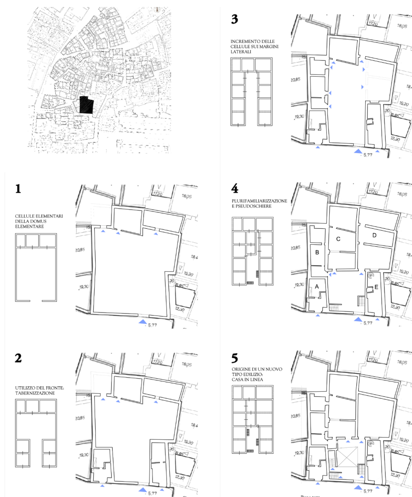
Fig. 8 - Il processo di insulizzazione in una casa a corte nelle vicinanze della basilica di San Nicola. Esempio di case a pseudo-schiera derivate dal consumo dello spazio aperto domestico della corte. The densification process in a courtyard house close to the San Nicola's basilica. Sample of pseudo-row houses deriving from the open domestic space consumption.
